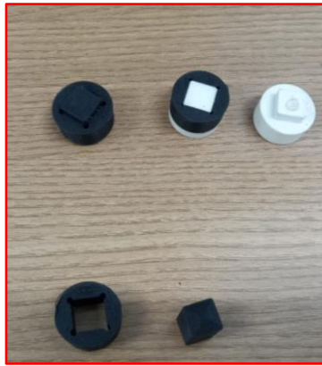
Figura 2(a). Peças impressas 3D para realizar testes de ajuste eixo-furo.
