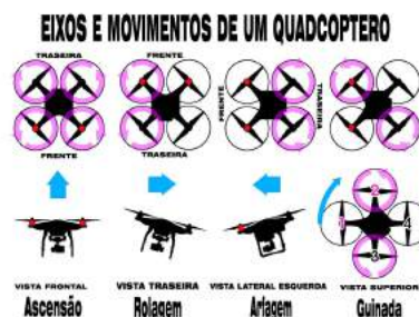
Figura 5. Eixos e movimentos de um Quadcóptero
