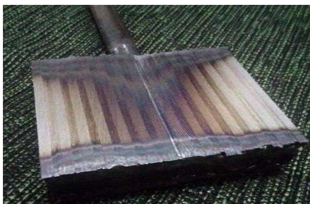
Figura 1. Lingote soldado e pronto para aquecer.
