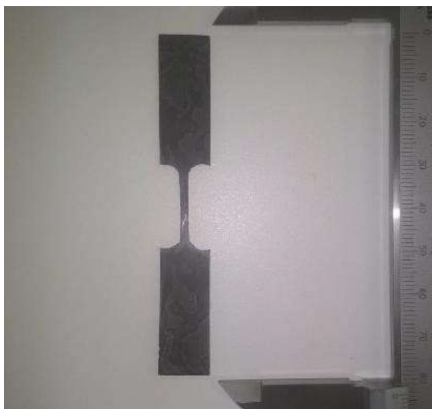
Figura 5. Corpo de prova após os ensaios de tração e dureza.
