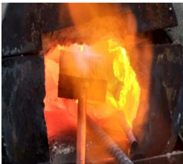
Figura 2. Aquecimento de lingote dentro da Forja
