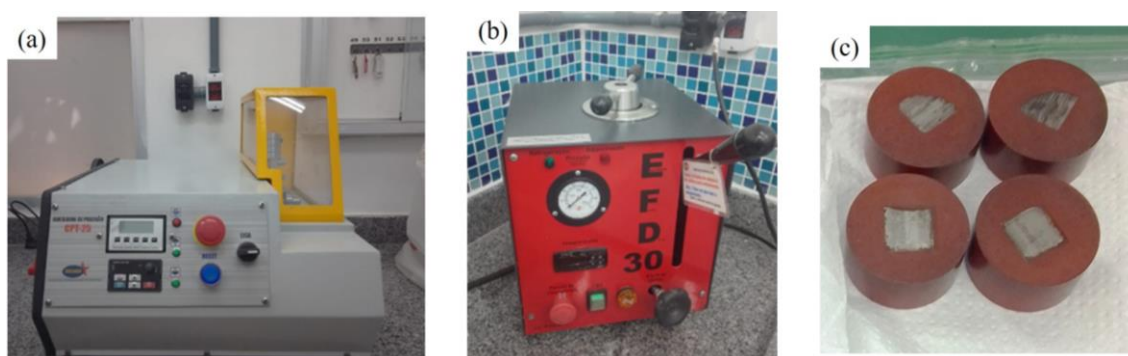
Figura 2. Preparação metalográfica. (a) Corte na cortadora de precisão; (b) Embutimento na embutidora metalográfica; (c) Seções das amostras embutidas, seção transversal e longitudinal
