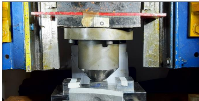
Figura 3. Corpo de prova DWT, após queda do martelo de altura 300mm (ASTM E208-17).
