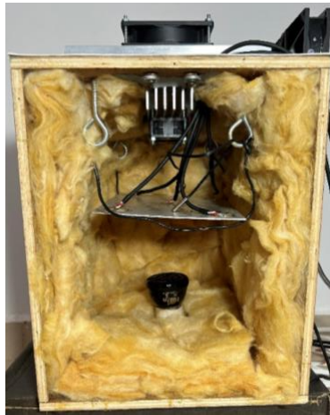
Figura 2. Câmera de controle de temperatura utilizada nos experimentos
