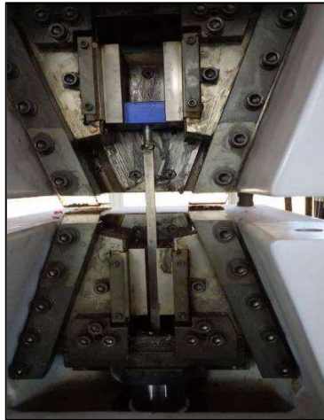
Figura 6. Parafuso soldado ao extensor para teste de tração
