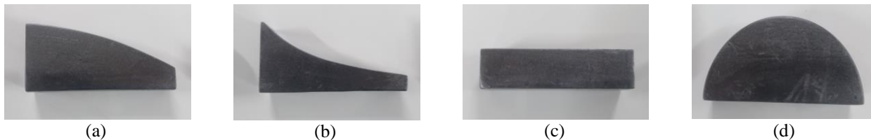
Figura 1. Perfil dos corpos de prova a , b , c e d para análise de carga distribuída Fonte: Autor (2022)
