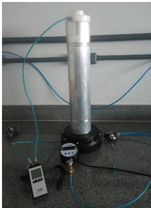
Figura 3. Experimento para medir perda de carga
