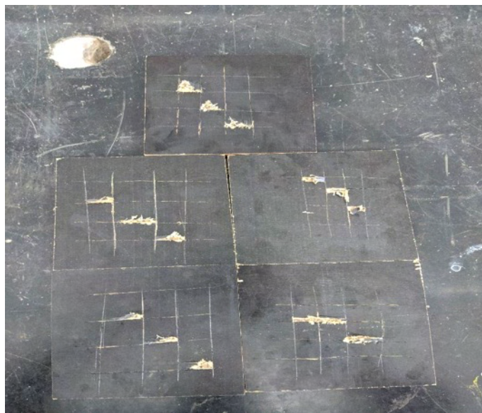
Figura 5. Corpos de prova com 18 mm após os ensaios de adesividade pelo método do corte transversal
