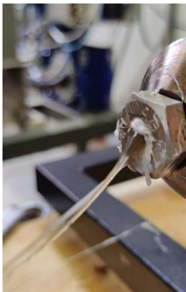
Figura 8. Teste realizado na extrusora para fabricação de filamentos, utilizando como material o polietileno tereftalato (PET) (Grupo de Ensaio e Simulações em Reservatórios - GESAR, 2022)
