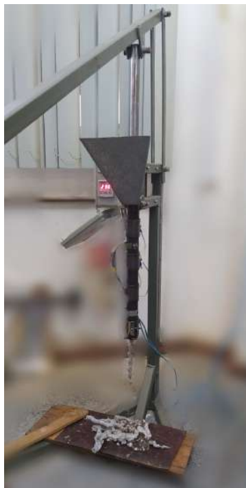
Figura 7. Teste realizado na injetora, utilizando PET (Grupo de Ensaio e Simulações em Reservatórios - GESAR, 2022)
