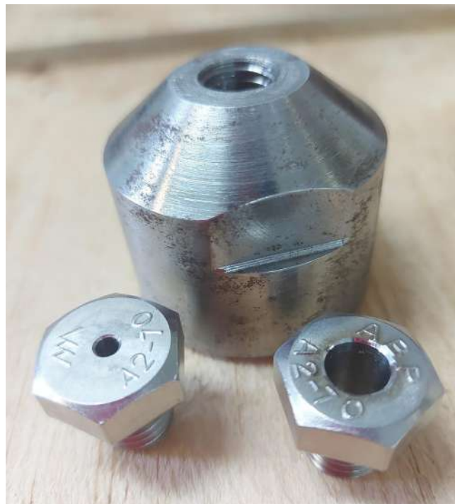
Figura 5. Bocal e bicos da extrusora, à esquerda bico de 3 mm e à direita de 8 mm (Grupo de Ensaio e Simulações em Reservatórios - GESAR, 2022)
