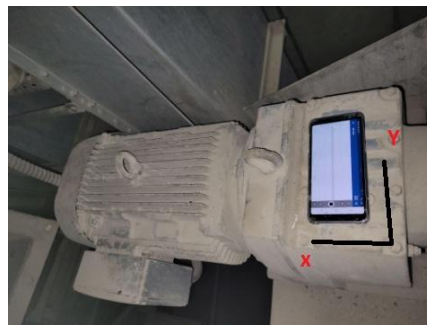
Figura 3. Celular posicionado para a obtenção do sinal de aceleração nos três eixos, representados os eixos X e Y
