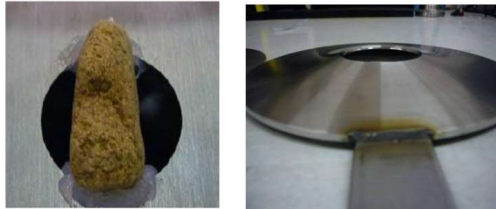
Figura 7 – Placa de orifício \beta = 0,5 : bloqueio parcial (a esquerda); empenamento (a direita) (Steven, 2010)
