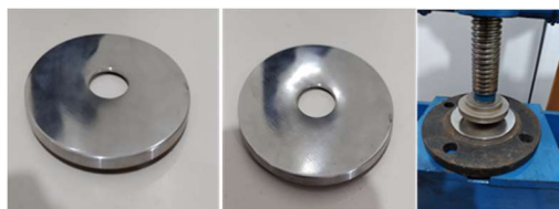
Figura 9 - Placa de orifício antes do empenamento (à esquerda); placa de orifício após o empenamento (ao centro); empenamento na prensa hidráulica (à direita)
