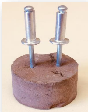
Figura 2. Típica amostra de argamassa para análise elétrica (Autoria própria, 2020)
