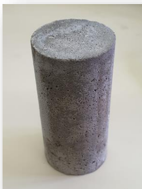
Figura 3. Amostra representativa com dimensões similares à de concreto utilizada nos testes de resistência mecânica (Autoria própria, 2020)
