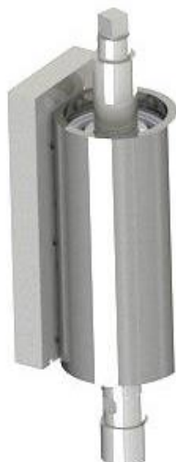
Figura 3. Maquete eletrônica de conjunto de adaptação para Mini Fresadora (Maciel et. al., 2016), realizado em conjunto por alunos e professores de engenharia utilizando Cálculo Numérico Computadorizado (CNC).
