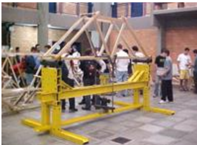
Figura 1. Bancada hidráulica para ensaios destrutivos de treliças (UFSC, 2003)
