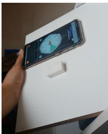
Figura 3. Experimento 1 (borracha na madeira revestida) quando o objeto está prestes a deslizar
