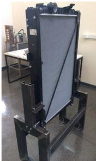
Figura 4. Fotografia do radiador automotivo utilizado na bancada estacionária (Autoria própria)
