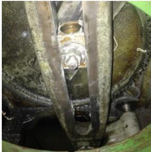
Figura 1. Mecanismo de retorno rápido da plaina limadora hospedada no USIMEC (Carneiro, 2018)
