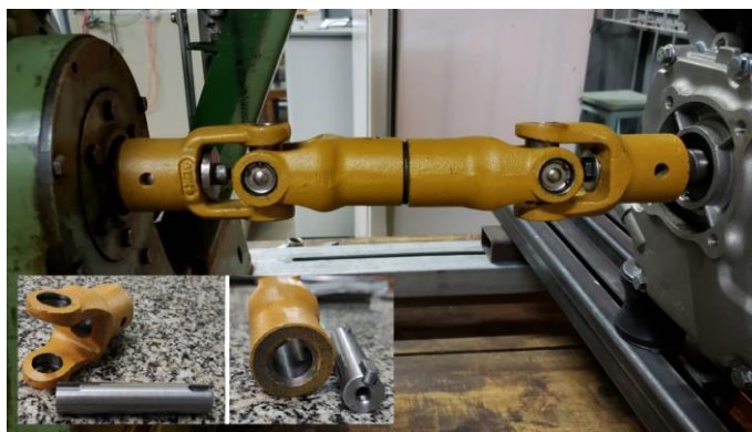
Figura 2: Acoplamento com juntas universais, cruzetas e eixo projetado sob medida (Autor próprio, 2020)
