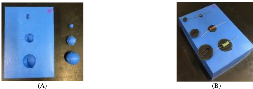
Figura 4. Modelo de Silicone: (A) Cavidades do Modelo de Silicone; (B) Inclusões com resistências (MENEGAZ, 2018)
