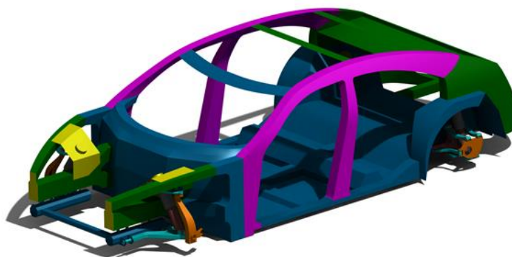
Figura 2. Modelo CAD de chassi underbody com elementos de suspensão
