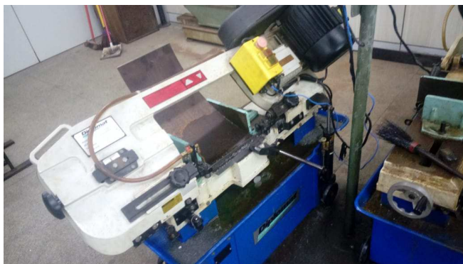
Figura 1. Serra automática realizando o corte da amostra do aço (Autores, 2020)
