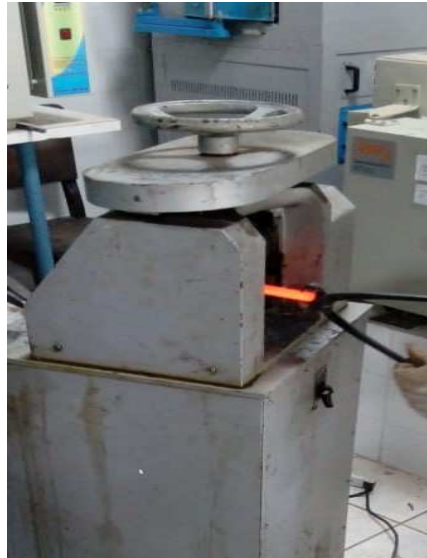
Figura 4. Peça sendo retirada do laminador para imediato resfriamento com água à temperatura ambiente (Autores, 2020)
