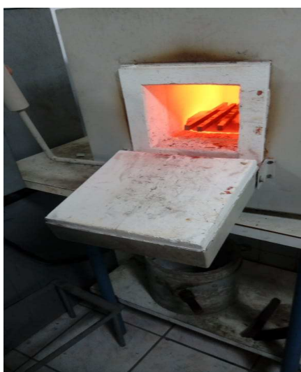
Figura 3. Peças colocadas no forno tipo mufla para processo de aquecimento (Autores, 2020)
