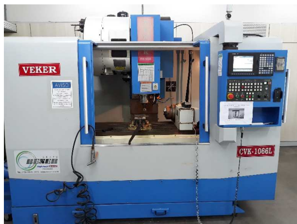
Figura 2. Máquina CNC utilizada para fresagem (Autores, 2020)
