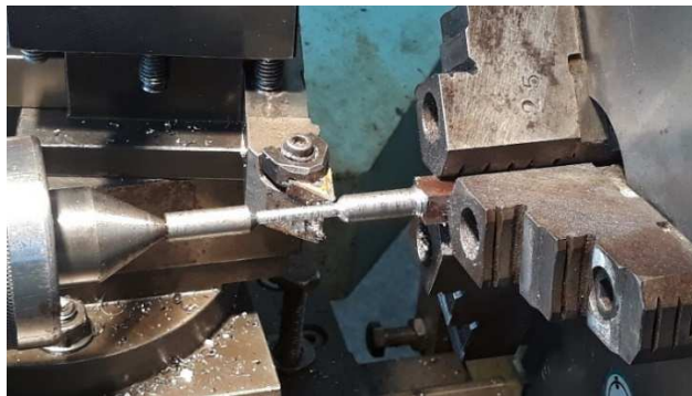
Figura 5. Processo de fabricação do corpo de prova no torno mecânico (Autores, 2020)
