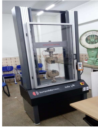
Figura 7. Máquina utilizada para ensaio de tração. (Autores, 2020)
