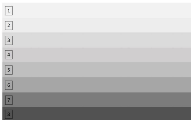
Figura 1. Ilustração da seção transversal da amostra de FGM com oito camadas em gradação funcional
