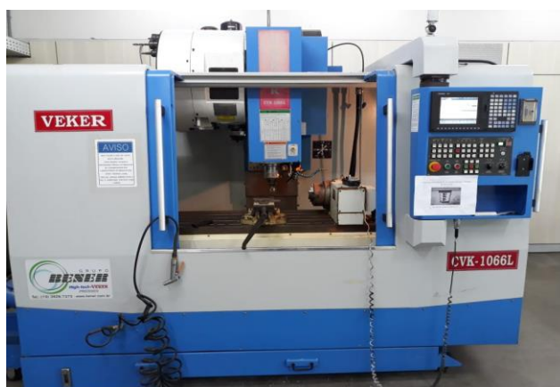
Figura 2. Centro de Usinagem CNC utilizado para fresar o material para fabricação das amostras (Autores, 2020)
