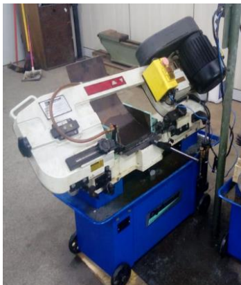
Figura 1. Serra utilizada para realizar o corte do material para fabricação das amostras (Autores, 2020)
