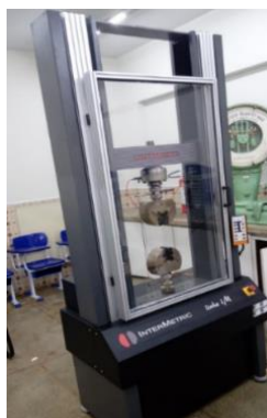
Figura 8. Máquina Universal de Ensaio InterMetric IM-200 (Autores, 2020)
