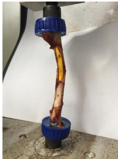
Figura 6: Deformação do osso implantado no ensaio de compressão
