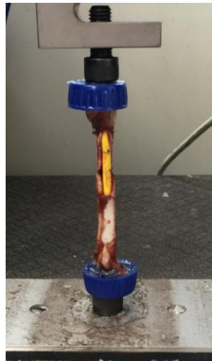
Figura 2: Osso com haste implantada, acoplado à tampinhas de garrafa com refina ortofitálica. (Autores, 2019)
