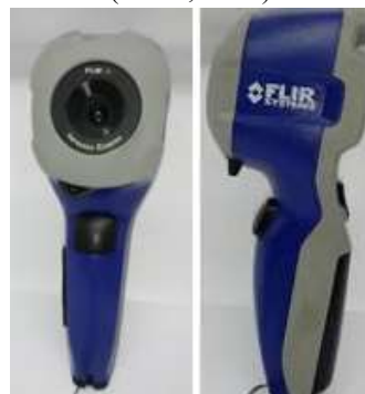
Figura 5: Câmera termográfica da fabricante FLIR, modelo E5 (Autor, 2017).
