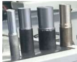
Figura 8: aço SAE 1020 1 ½"; aço SAE 1045 2"; bronze SAE 65 1 ½"; duralumínio 7075- T651 (Autor, 2017).
