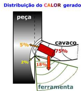
Figura 2: Distribuição do calor gerado durante processo de usinagem (CIMM, 2010).
