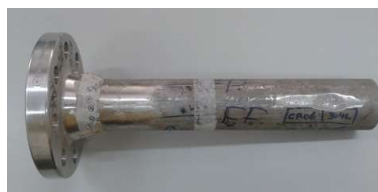
Figura 5 - CP 06, TP304L, Tubo + Flange de Pescoço (Autor, 2017)
