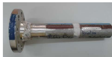
Figura 3 - CP 03, TP347, Tubo + Flange de Pescoço (Autor, 2017)
