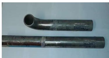
Figura 1 - CP 01, TP347, Tubo + Tubo e CP 05, TP304L, Tubo + Curva (Autor, 2017)
