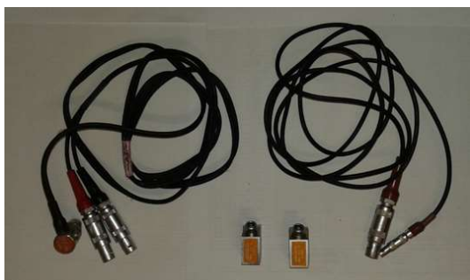
Figura 7 - Transdutores e Cabos Coaxiais (Autor, 2017)
