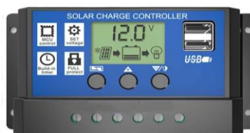
Figura 4 - Regulador de carga - E-WIRELESS fonte: Edson Luz, 2019
