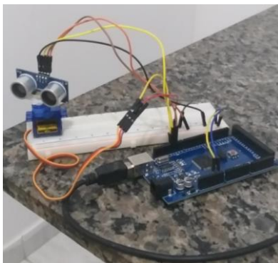
Figura 1. Protótipo do radar com o sensor ultrassônico acoplado ao servo motor (próprio autor, 2019)
