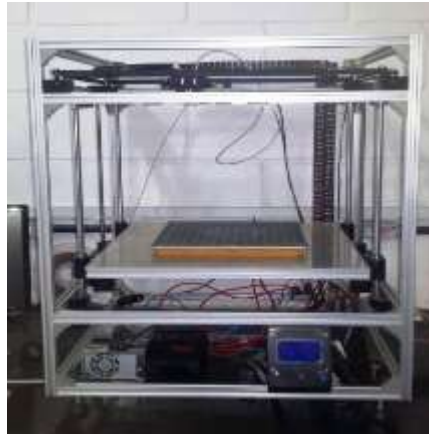
Figura 15. Montagem finalizada da impressora 3D (Autores, 2019)
