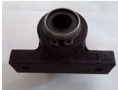
Figura 3. Peça mancal onde é fixada o rolamento da guia (Autores, 2019)
