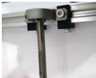
Figura 7. Peça de fixação fuso e peça de fixação do motor Z (Autores, 2019)
