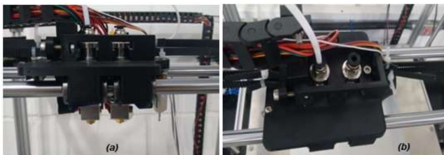
Figura 8. Peça suporte Hotend e guias lineares eixo X (Autores, 2019)
