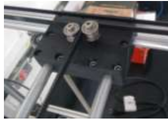
Figura 9. Peça suporte guias XY (Autores, 2019)
