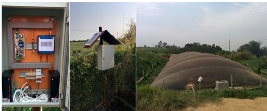
Figura 2 – Sistema eletrônico para controle de biodigestores.
