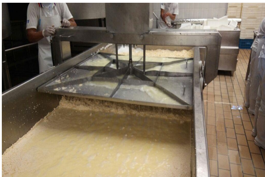
Figura 9. Protótipo da nova da Dreno Prensa (Autoria Própria, 2017)
