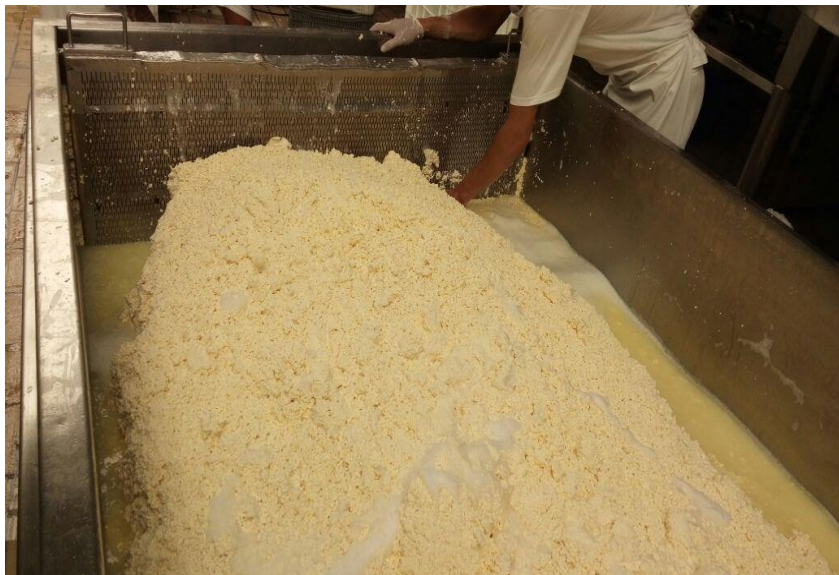
Figura 1. Massa de queijo apresenta um resultado insatisfatório pós primeira prensagem. (Autoria própria, 2017)
