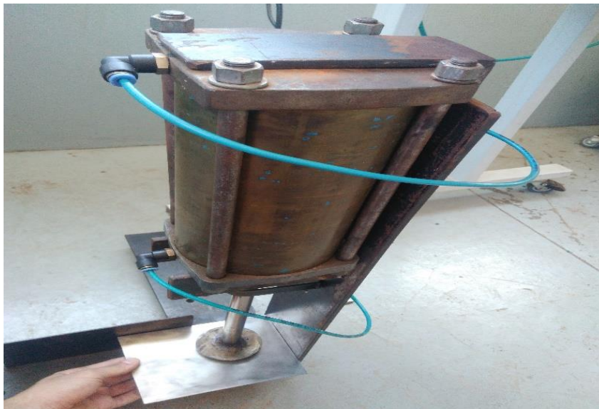
Figura 4. Teste de pistão com a base modificada (Autoria própria, 2017)
