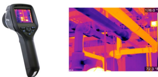
Figura 3. Câmera termográfica Flir E30 e exemplo de imagem térmica (Flir, 2019)
