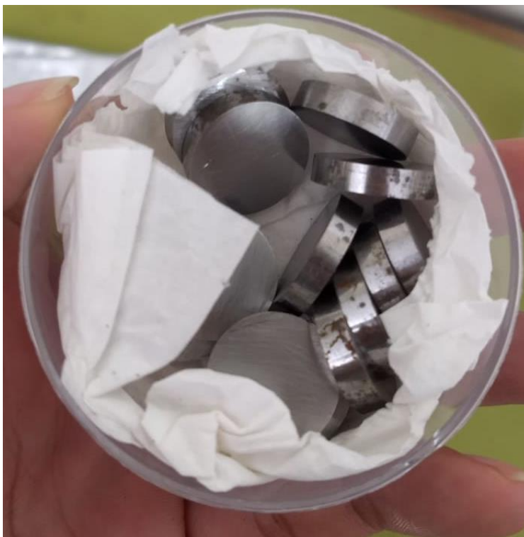
Figura 1 – Amostras de aço AISI O1 para o processo TDVC (elaborada pelo autor).
