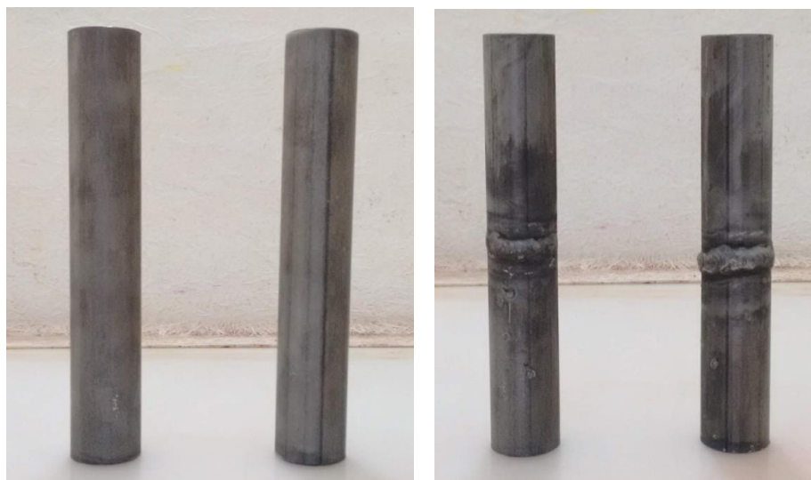
Figura 4. – Conjuntos de (a) controle e (b) eletrodo revestido oxidados (autoria própria)
