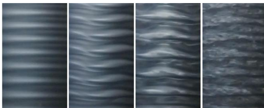
Figura 2: Formação da instabilidade Taylor-Couette (ALPhA, 2019)
