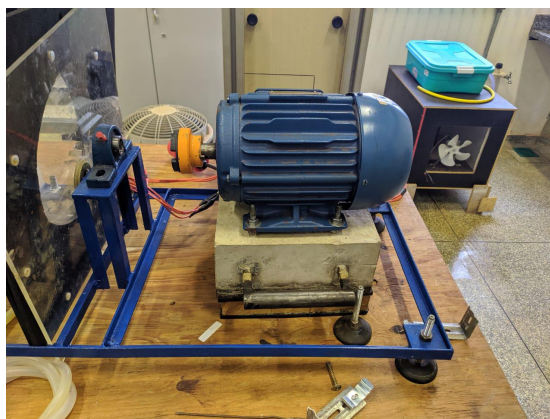
Figura 5: Motor sobre a base de concreto
