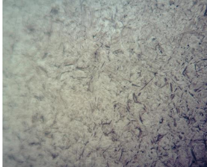
Figura 3. Imagem do constituinte martensita com aumento de 600 vezes (Matos, Thairan Ramos da Costa, 2018)
