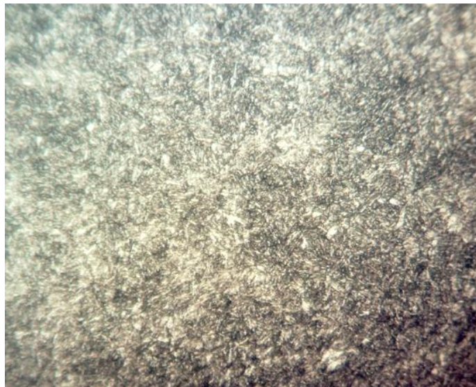
Figura 4. Imagem do constituinte sorbita com aumento de 600 vezes (Matos, Thairan Ramos da Costa, 2018)
