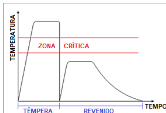
Figura 2. Diagrama do tratamento térmico (Matos, Thairan Ramos da Costa, 2018)
