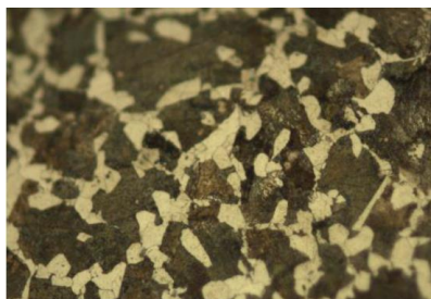
Figura 3. Microestrutura do corpo de prova aço ABNT 1045. Ataque: Nital 10%, 50x (Autor, 2019)
