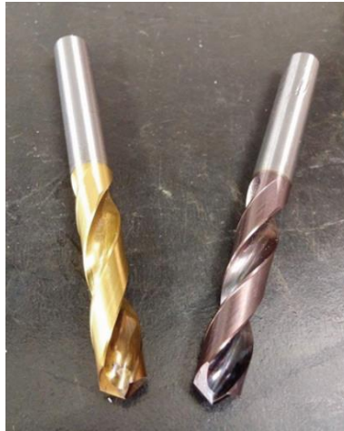
Figura 4. Brocas utilizadas no projeto revestidas por TiN, lado esquerdo, e TiAlN, lado direito (Autor, 2019)
