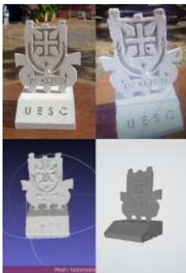
Figura 4. Procedimento realizado para o escaneamento 3D da peça feita na impressora 3D (Autores, 2019)
