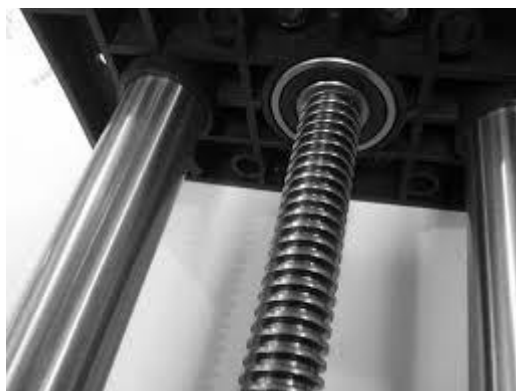
Figura 2. Exemplo de sistema de elevação com fuso (A.T.I Brasil – 2010)
