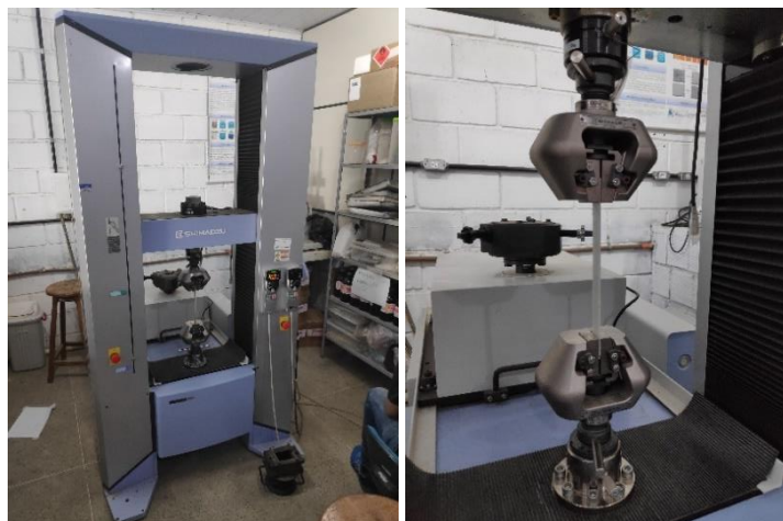
Figura 3. Máquina universal de ensaios modelo Shimadzu Autograph AG-X Plus (à esquerda). Corpo de prova posicionado na máquina universal de ensaios (à direita) (Autoria própria, 2019)
