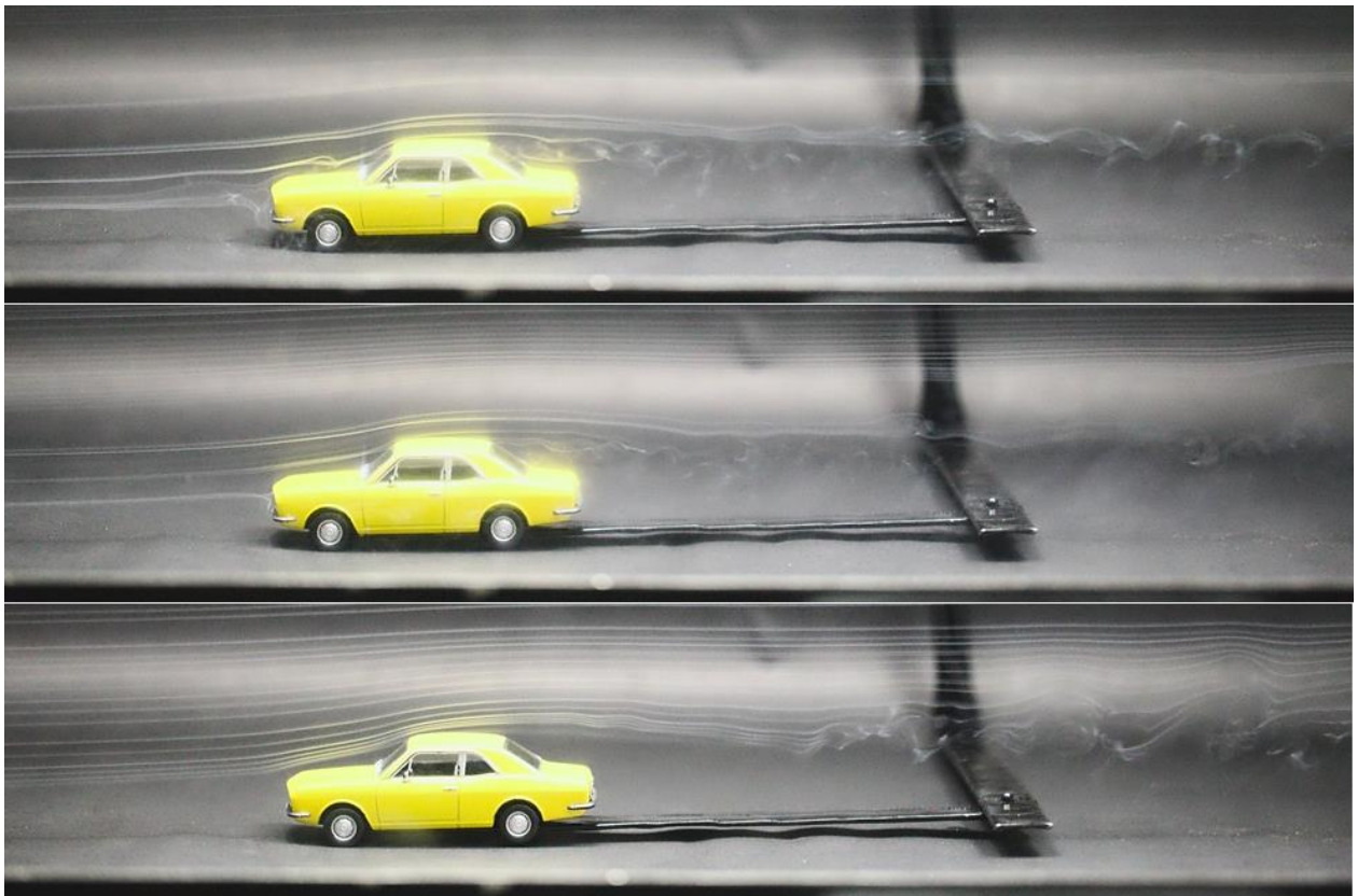
Figura 10. Linhas de corrente feita com fumaça (traçador) no método experimental.
