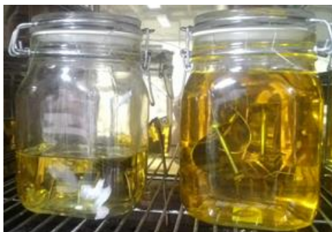
Figura 4. Imersão dos corpos de provas em biodiesel e diesel S30
