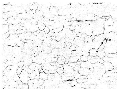
Figura 7. Imagem da micrografia tratada em software da superfície da amostra do aço AISI após a imersão em biodiesel
