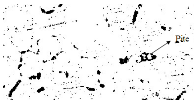
Figura 9. Micrografia tratada superfície da amostra do aço AISI após a imersão em diesel S30.
