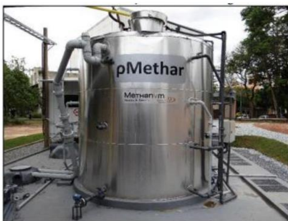
Figura 3. Reator de metanização de resíduos orgânicos (Ferreira, 2015)
