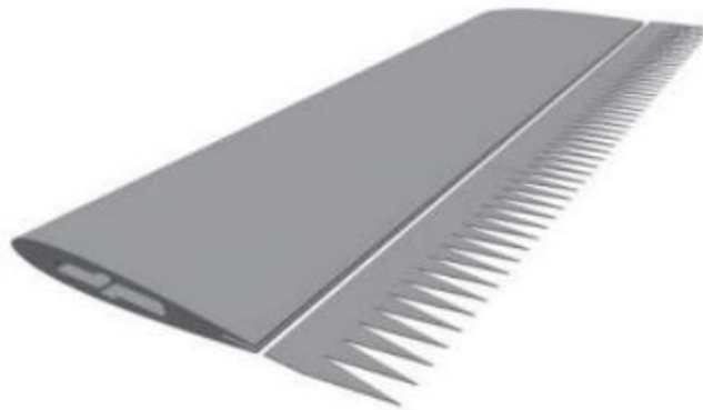
Figura 2: Vista de montagem no CAD do NACA 0012 com a inserção do serrilhado (Liu, et al. , 2015)
