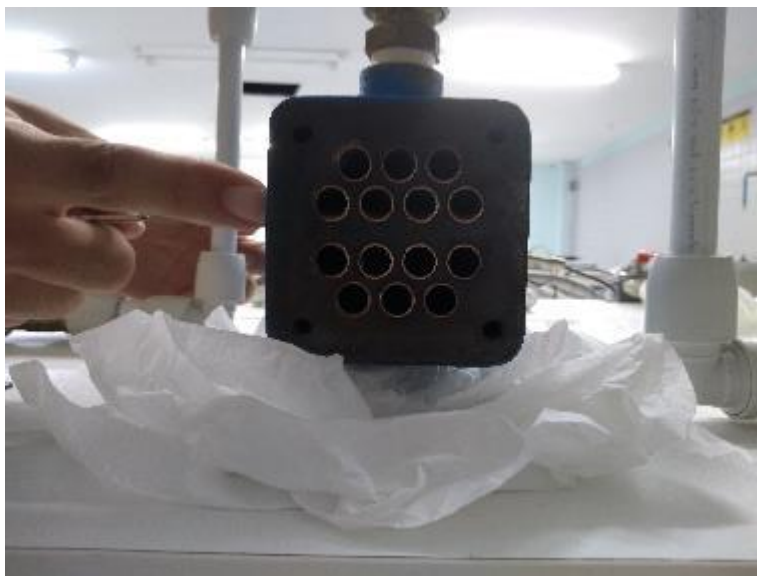
Figura 2. Tubos mandrilados no espelho
