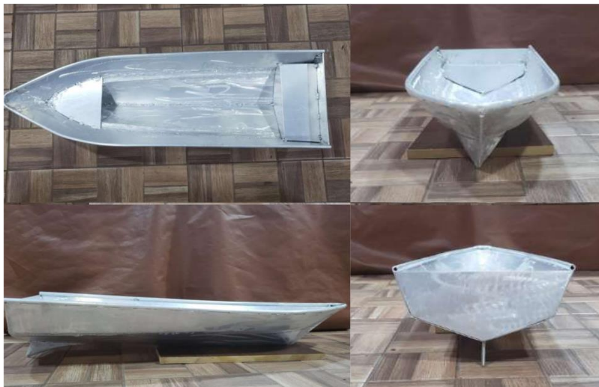
Figura 4. Protótipo da embarcação do SAMU construído em escala 1:10
