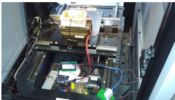
Figura 12 - Sistema completo no tribômetro (O próprio autor)
