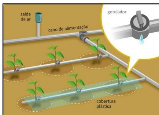
Figura 1. Modelo de um sistema de irrigação por gotejamento (Ciminos, 2013)
